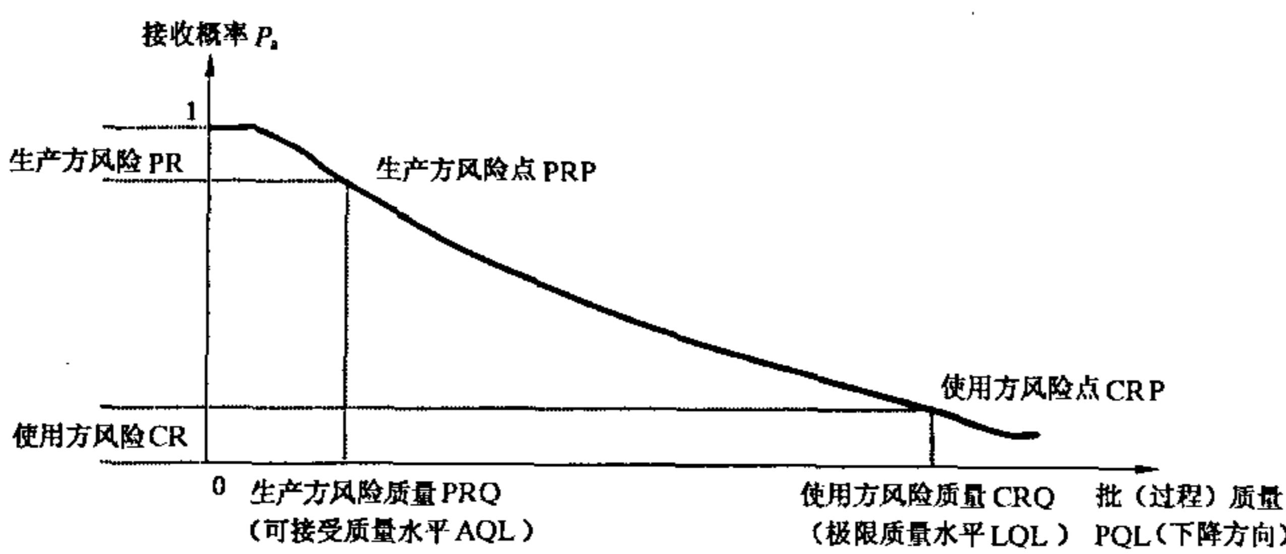
图 1 抽检特性曲线(OC 曲线)
